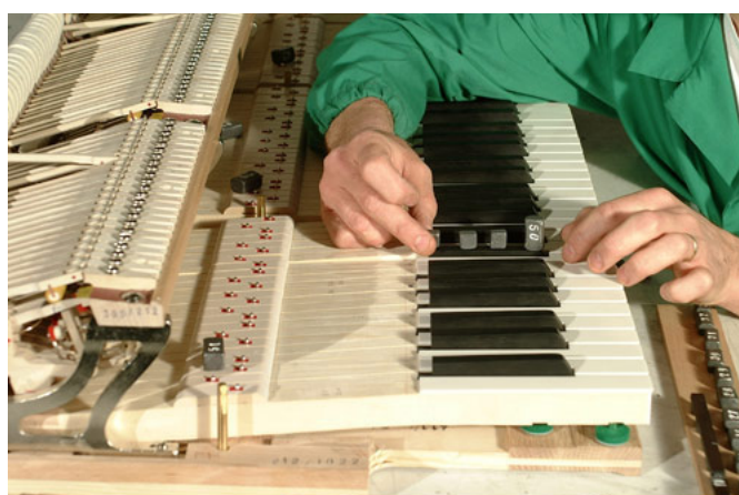
Fazioli-Posizionamento dei contrappesi di piombo da inserirsi nel tasto.
