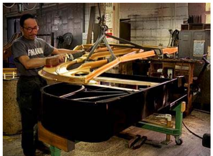
Steinway & Sons – Montaggio telaio in ghisa
