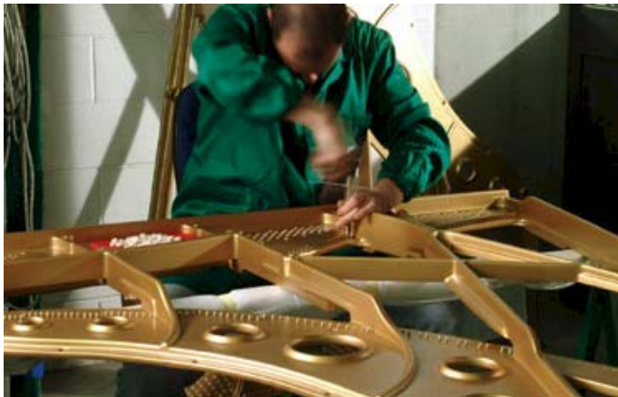
Fazioli- Montaggio telaio in ghisa
