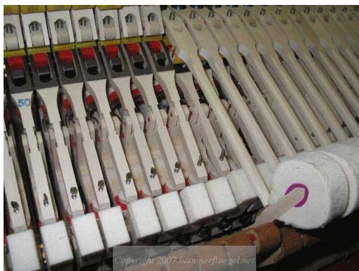
Steinway & Sons – Particolare meccanica con vista stiletto completo
