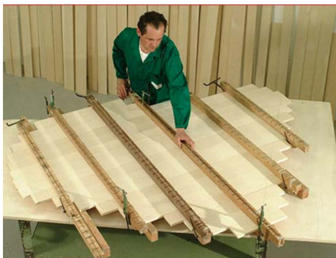
Fazioli - Incollaggio delle assi componenti la tavola armonica
